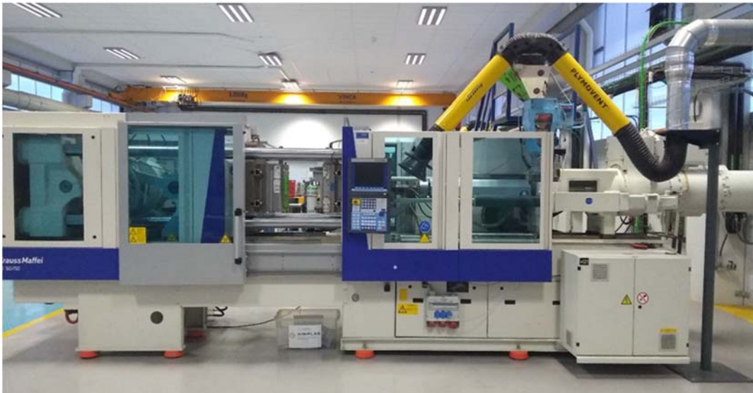
Figura 24 - Inyectora KraussMaffei KM 160 EX (160 TN), Inyectora con una unidad para la inyección – Unidad 1
