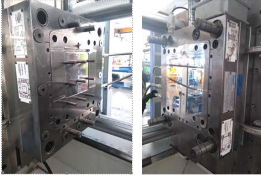
Figura 29 - Molde empleado para el experimental del sector automoción
