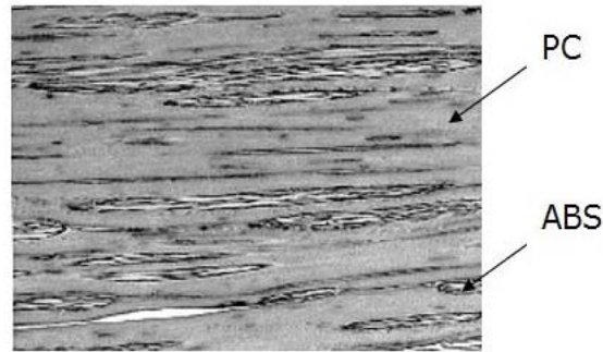
Figura 22 - Micrografía de una mezcla PC+ABS. Podemos observar la heterogeneidad en la mezcla de los dos componentes, cada uno con sus propiedades singulares.
