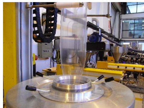
Anillo de enfriamiento de doble labio
