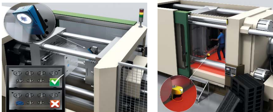
Izda.: Sensor que detecta si se ha quedado una pieza en alguna cavidad del molde. Dcha.: Sensor que detecta si hay alguien en el interior de la unidad de cierre del molde.
