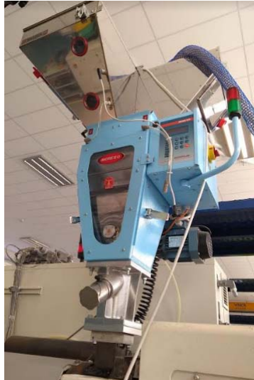
Figura 25 - Dosificador MORETTO DPM 24X instalado en la inyectora KRAUSS MAFFEI
