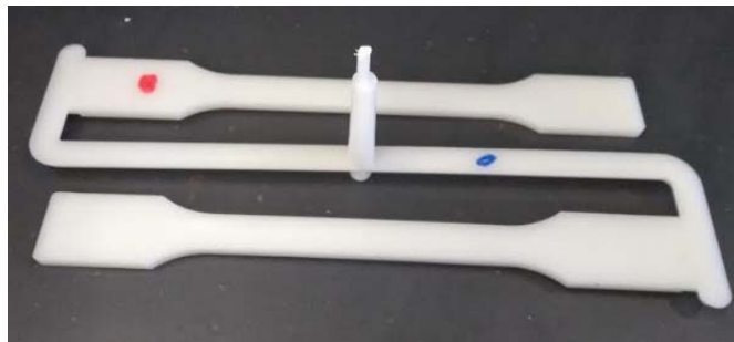
Posicionamiento de los sensores de presión en cavidad en una probeta normalizada
