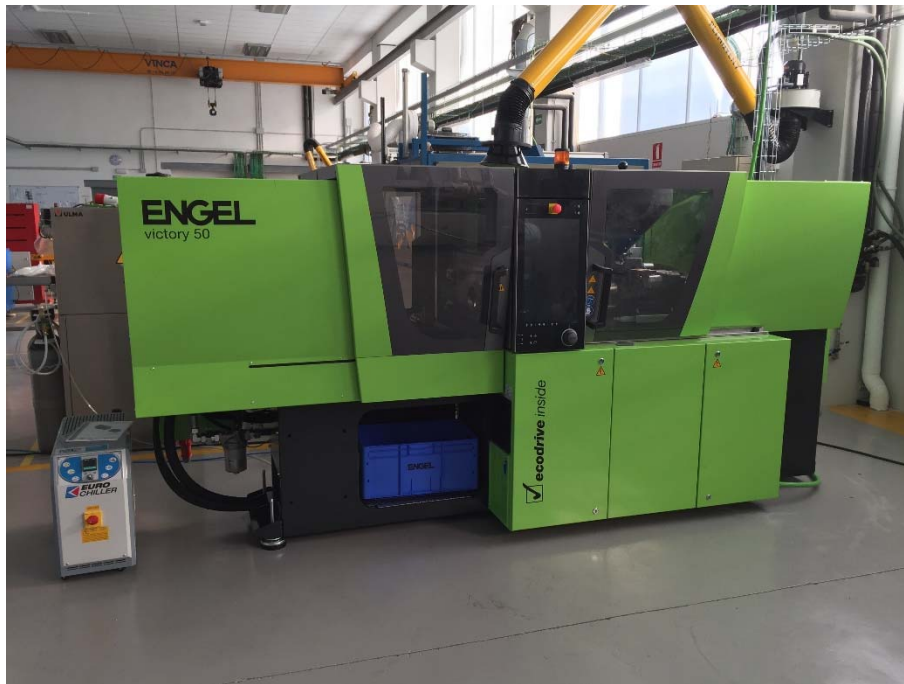
Figura 30 Inyectora ENGEL Victory 50 TN, Inyectora con una unidad para la inyección
