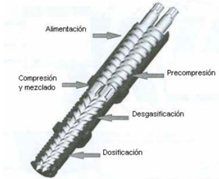
Figura 109. Husillos de una extrusora cónica.
