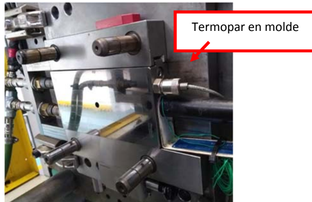
Termopar colocado en la cavidad fija del molde para controlar la temperatura a la que se encuentra en todo momento.
