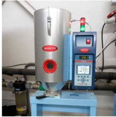
Figura 28 - Deshumidificador MORETTO XD2T utilizado para secar el PC-ABS
