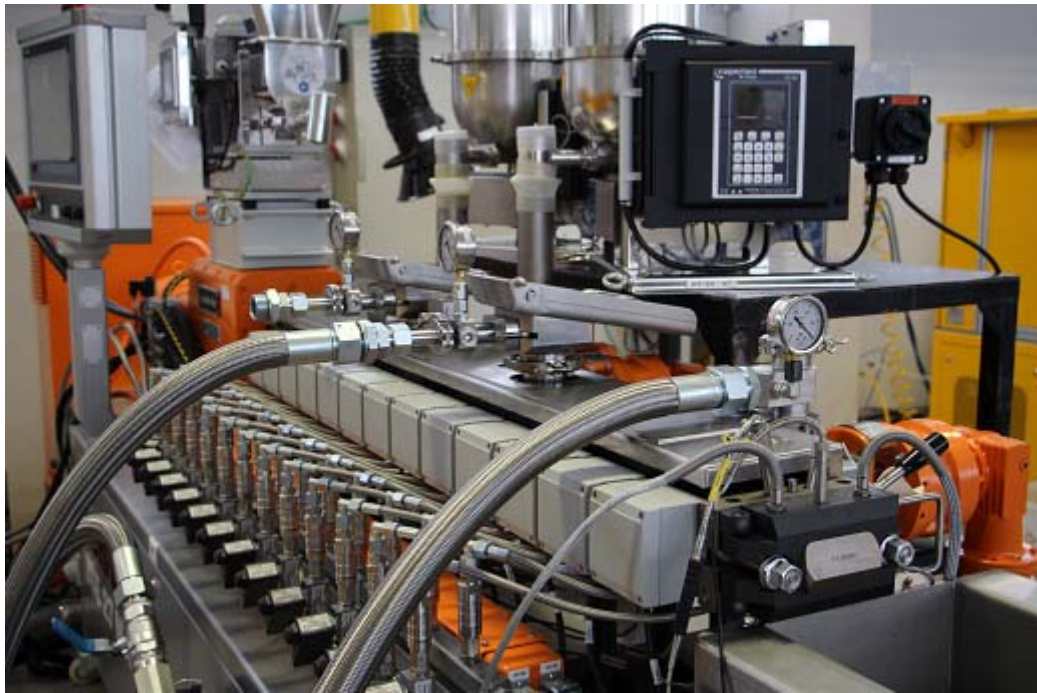
Figura 111. Extrusora co-rotativa de doble husillo Leistritz Maxx 27.
