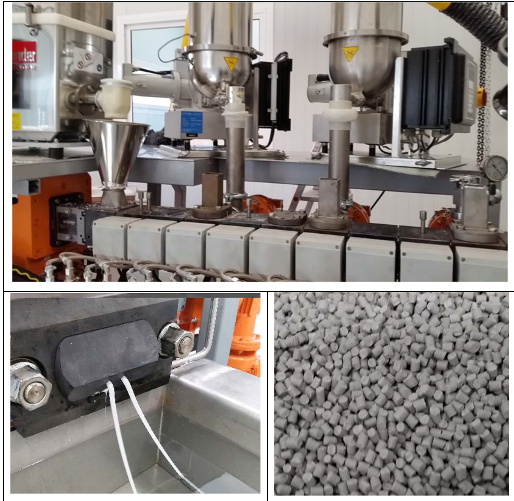
Figura 124. Extrusión de compuestos en la extrusora Leistritz SME 27MAXX.
