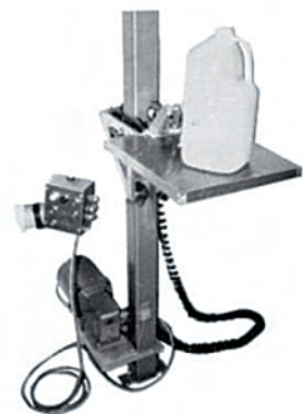
Figura 32. Equipo empleado en el ensayo de impacto por caída libre.
