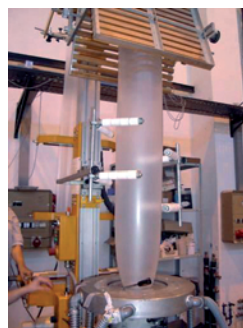
Figura 4. Esquema del proceso de extrusión soplado de globo e imagen del globo formado por el film plástico.
