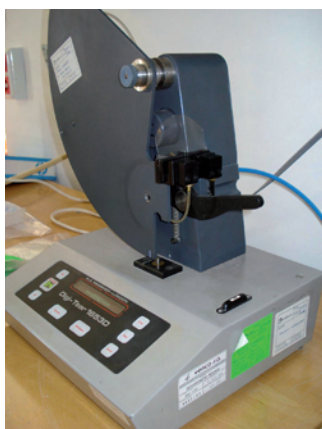
Figura 33. Equipo de rasgado Elmendorf y ejemplo de probetas empleadas.
