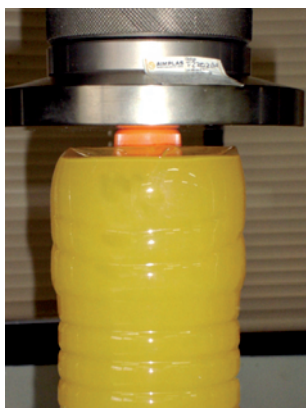
Figura 24. Ejemplo de un ensayo de compresión sobre botella.
