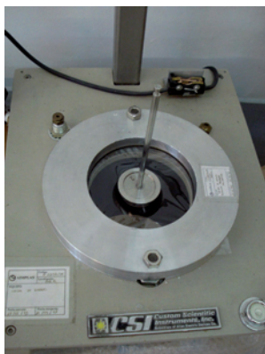
Figura 31. Detalle de la zona de impacto del dardo sobre la probeta de film colocada en el bastidor durante el ensayo de impacto dardo.
